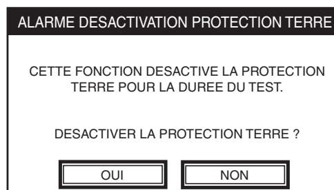
Figure 44 – Écran « Alarme désactivation protection terre »
