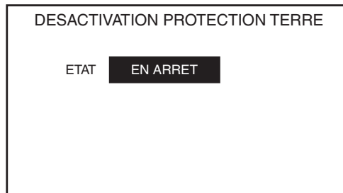
Figure 47 – Écran d'arrêt de désactivation protection terre
